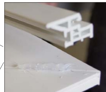
Fig. 4 Unghiatra Sigillatura prima di montare la battuta centrale
