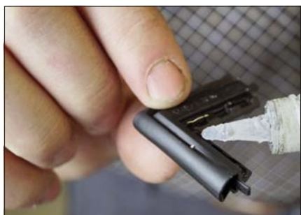
Fig. 1 Preparazione incollaggio dell'angolo dell'anta.
