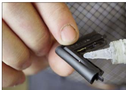
Fig. 4 Preparazione all'incollaggio all'angolo dell'anta
