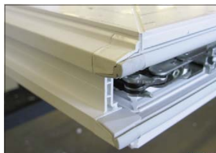
Fig. 2 Guarnizione G152 incollata a M439R/L nella parte inferiore dell'anta mobile.
