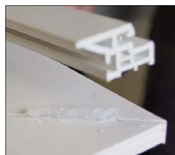
Sigillatura della scanalatura sull'anta prima di montare la battuta centrale
