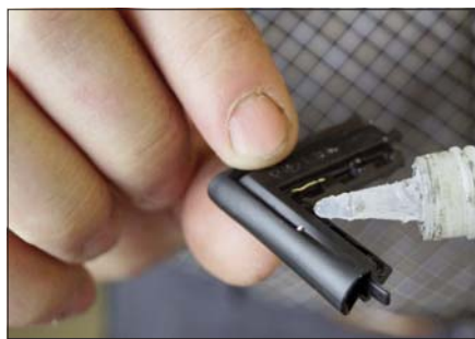
Fig. 4 Preparazione all'incollaggio all'angolo dell'anta
