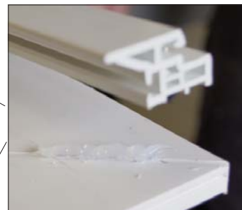
Fig. 4 Unghiatura Sigillatura prima di montare la battuta centrale
