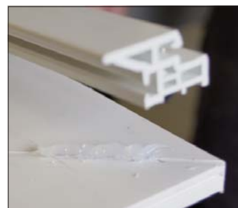
Sigillatura del fondo della scanalatura sull'anta prima del montaggio della battuta centrale
